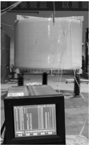
图5 热稳定性试验中的电抗器 Fig. 5 Reator in thermal stability test
